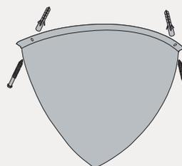
> À fixer en angle sur un mur avec chevilles et vis fournies
